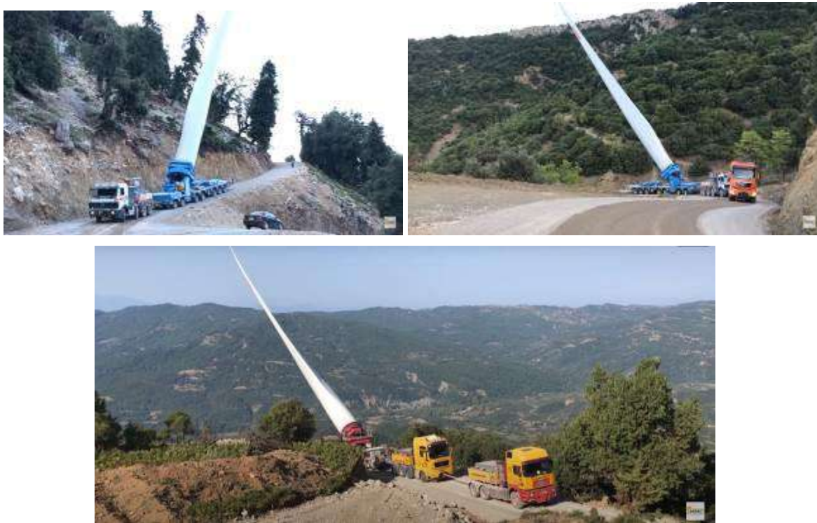
Слика 23 Транспорт на делови од ветерната турбина (Извор: Google)
